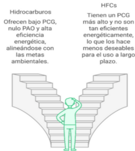
Figura 1. Elección del refrigerante: hidrocarburos frente a HFC en sistemas de refrigeración. Fuente: Gildardo Yañez.
