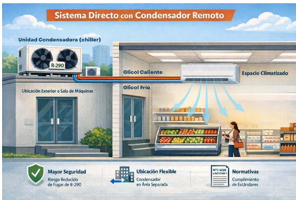
Figura 8. Sistema directo con unidad condensadora remota. Fuente: Gildardo Yañez.
